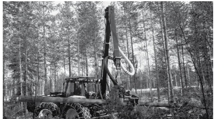
Mit einem Harvester lässt sich die Windwurfaufarbeitung am sichersten erledigen.
